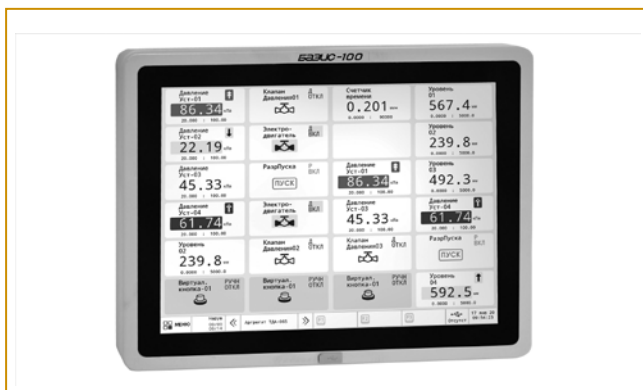
Рис. 2 Панель управления ПЛК БАЗИС-100
